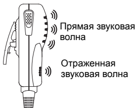
Рис. 2. Конструкция рефлексного порта
